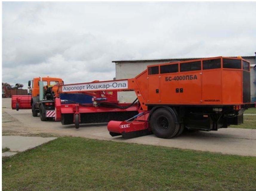
Плужно-щеточная продувочная аэродромная уборочная машина БС-4000ПБА-2Р предназначена для круглогодичной уборки снега, льдообразований, изморози, наледи, слякоти, грязи на ИВПП, РД, приангарных площадках и прочих больших площадях аэродрома с искусственным покрытием.
